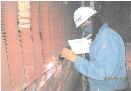
ตรวจสอบสภาพพ่นน้ำทั่วๆไปภายในหม้อน้ำ LP Pressure หม้อไอน้ำหมายเลข 1 ( HRSG-01 ) บริษัทสหโคเจน (ชลบุรี) จำกัด(มหาชน) วันที่ 15 เมษายน 2565
