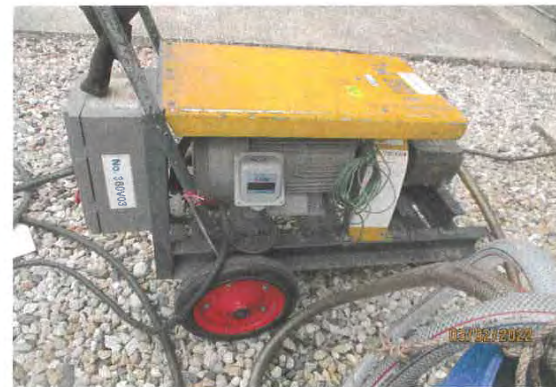
Pump ความดันสูงที่ใช้ในการอัดน้ำทดสอบ (Hydrostatic Test ) หม้อไอน้ำหมายเลข 2 ( HRS-02 ) บริษัทสหโคเจน (ชลบุรี) จำกัด(มหาชน) วันที่ 3 กุมภาพันธ์ 2565
