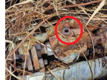
Plug Drain และ เกสียวใน ของ Steam Trap ขาด
