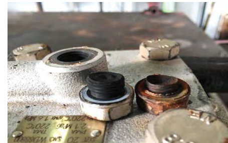
ปลั๊ก Body Steam Trap ตัวเก่าที่ชำรุด & ตัวเก่าที่สภาพปกติ
